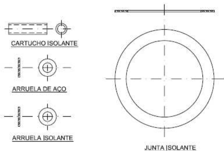
FIGURA L – INSTALAÇÃO DE JUNTA ISOLANTE PLANA EM FLANGES TIPO RF
